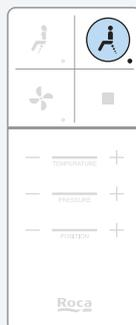
Se activa la cánula en posición atrasada (para el lavado anal) y su correspondiente función oscilante.
